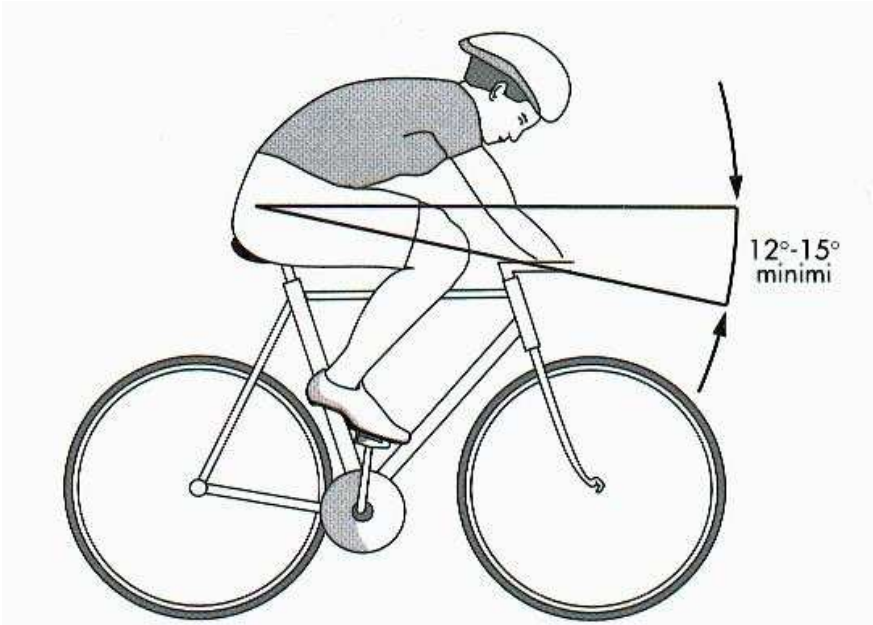
Fig.18 - Metodo per la determinazione della lunghezza delle pedivelle.
